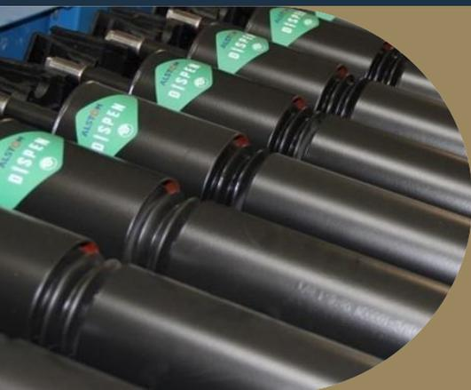
铁道车辆悬挂系统的运动大多数情况下振幅较小且频率较高。Dispens油压减振器采用了适用于上述运动特点的活塞杆密封技术，其运用可靠性较传统密封大大提高。同时，Dispens减振器装有一个密封的弹性气囊，其内部充满一个大气压空气，它的“呼吸”可弥补贮油腔内油的体积变化，从而使贮油腔中的空气和油之间不再直接接触，因而不会产生乳化现象，保证了有效减振，同时，气囊膨胀可在贮油腔内产生一个微弱的正压，使油在回流阶段迅速回到工作缸，充分保证了减振器的性能。由于Dispens油压减振器的应用，旅客的舒适度和安全性将会得到极大的改善。
